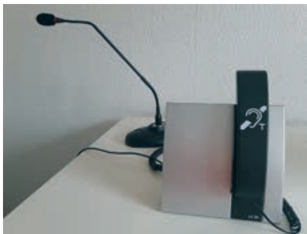
Abb. 3: Mit einem Ringschleifenverstärker kann an der Anmeldung das Gespräch direkt auf das Hörgerät übertragen werden oder, wie hier zu sehen, über den Hörer des Verstärkers besser empfangen werden.
